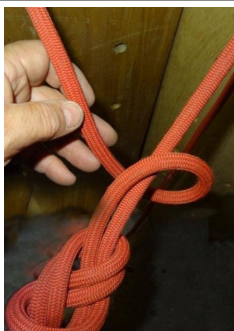
10) réalisation du nœud d'arrêt dit de « capucin »
